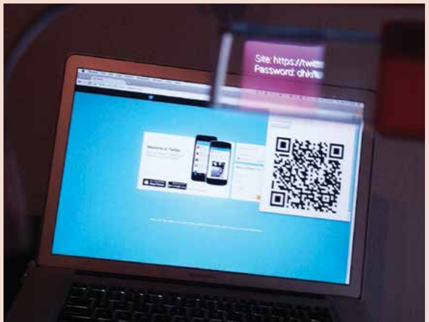
图 5. 原型 AR 密码管理器。我们的 Chrome 扩展（背景）显示了表示当前网站的 QR 码。响应语音命令“find password”时，我们的 Google Glass 应用程序（前景）扫描此 QR 码，并在平视式显示屏上私密地显示为该网站存储的密码。
