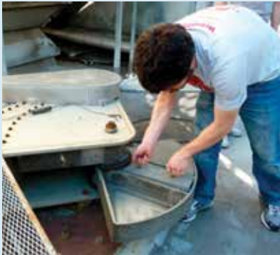
图 6 偏心重块晃动 Millikan 图书馆，说明 CSN 硬件对建筑物的共振频率敏感。
